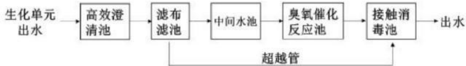
图 5.8-2 提标改造工艺流程图
